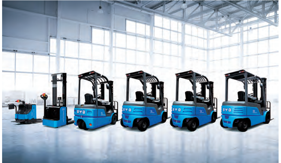
BYD bietet sein gesamtes Produktspektrum an Flurförderzeugen, vom Deichselhubwagen bis zum Gegengewichtstapler, mit Lithium-Eisenphosphat-Batterien an.
