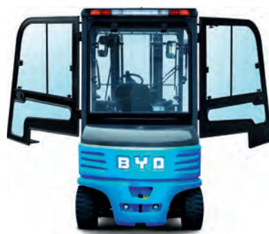
Für den Einsatz im Freien oder in Kühlbereichen ist eine Vollstahl-Kabine mit integrierter Heizung erhältlich.
