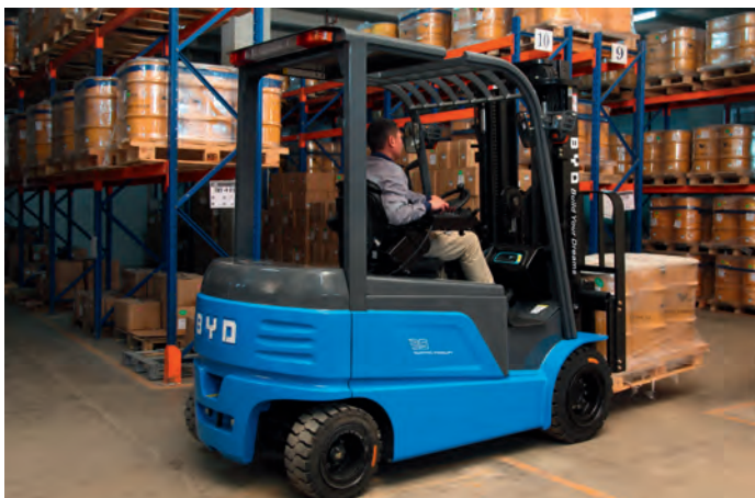
Der Vierrad-Gegengewichtstapler ECB35 mit einer Tragfähigkeit von 3,5 t erreicht eine Höchstgeschwindigkeit von 20 km/h.
