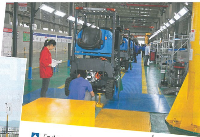
▴ Endmontage in Shoaguan – die Dame mit dem roten Kittel kontrolliert die Arbeitsschritte der vorherigen Stationen.
