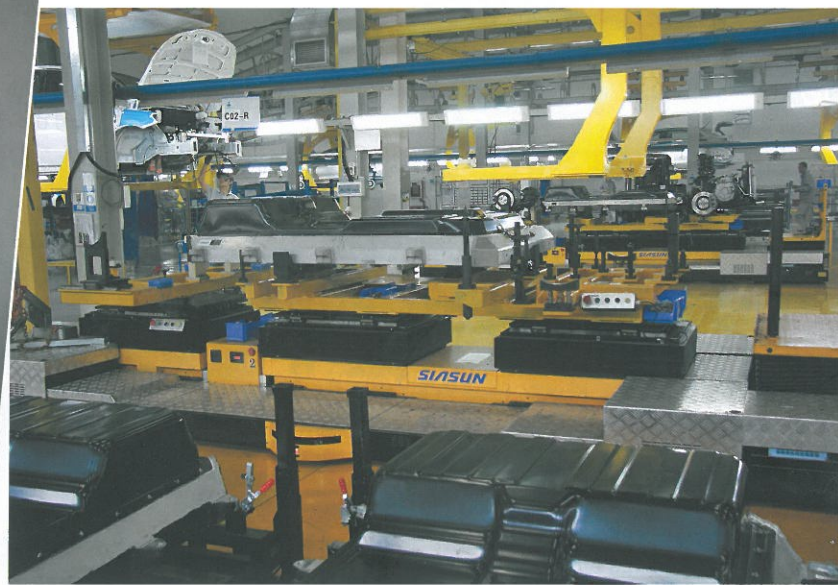
Lithium-Eisenphosphat-Batterie für den Denza (60.000 Stück/Jahr), dieses reine E-Automobil fertigt BYD zusammen mit Mercedes Benz für den chinesischen Markt – 50.000 Euro kostet es, abzüglich aller staatlichen Förderungen bleiben rund 15.000 Euro am Endkunden „hängen“.
