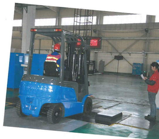
Fast geschäft – auf dem Rollenprüfstand werden die Stapler final getestet und mit einem individuellen Testprotokoll für den Versand vorbereitet. ▾
